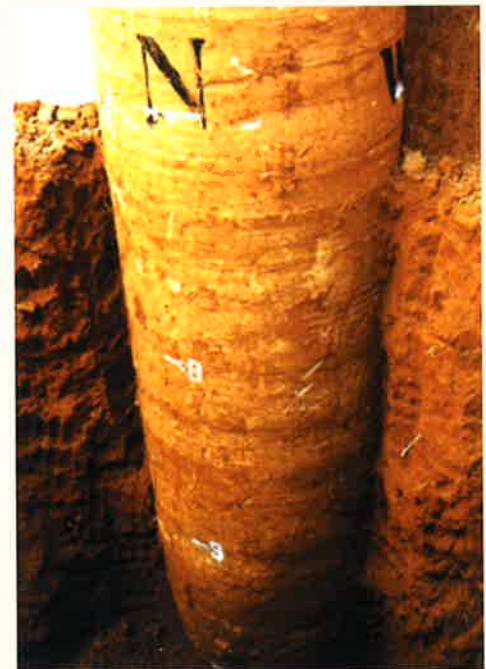
土槽載荷試験後のHYSC杭
