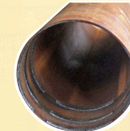
(鋼管下端部突起リング)
