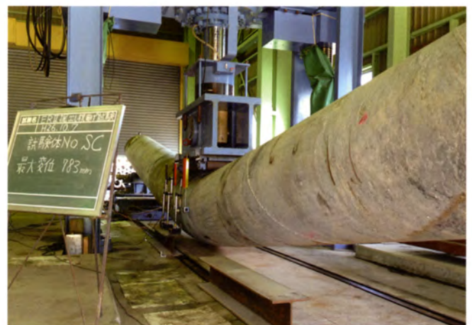
掘出した杭による曲げ試験
