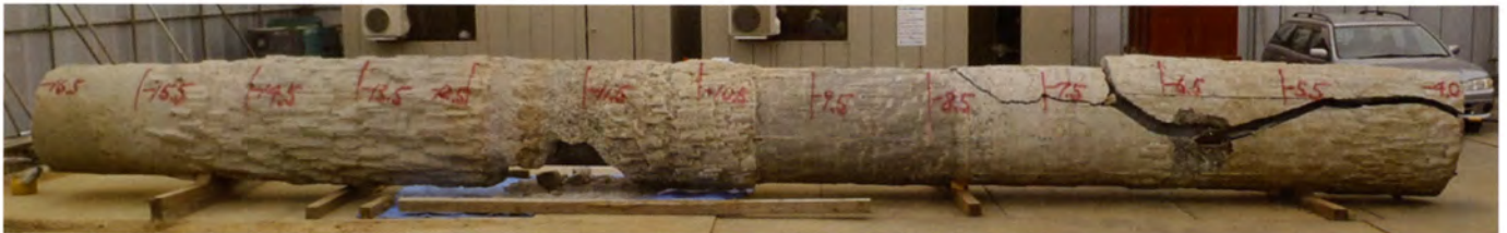
掘出した杭の全景
